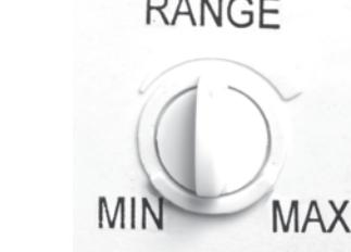
Tome nota de los dos controles en la parte inferior del detector. El control de GAMA o "RANGE" (sensibilidad del detector) se localiza en la parte inferior izquierda.
